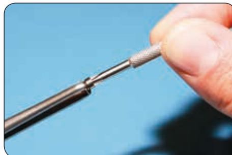
8: Каждая 1/4 доля оборота увеличивает / уменьшает прочность удерживания приблизительно на 200г.
